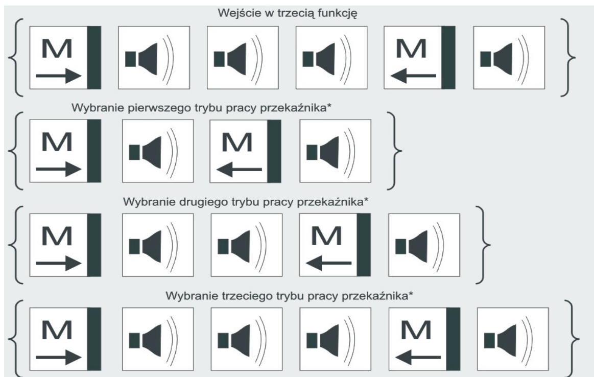
Rys.5 Wybór trybu pracy przekaźnika
